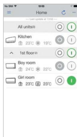
Řízení provozního režimu, teploty, čištění vzduchu, otáček ventilátoru a směru proudění
